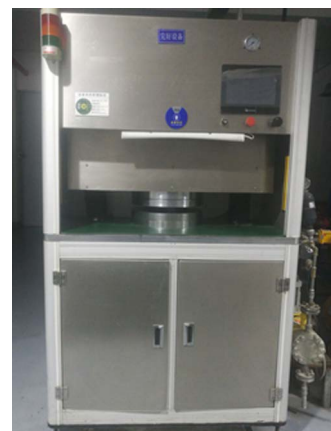
图14 PCMA-250磨粒流加工设备
