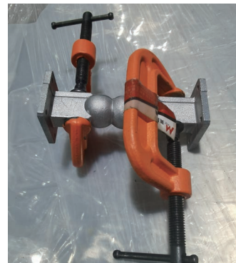
图13 G形夹夹紧波导管示意
